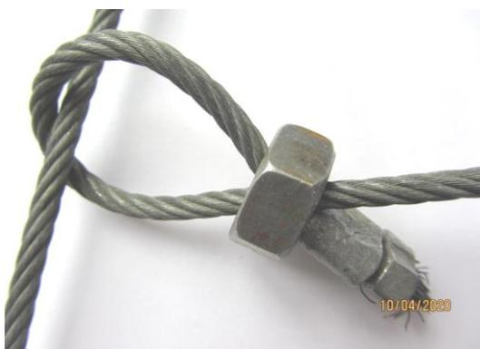
**Рисунок 2 – Стопор на петле «гаечного» типа**
